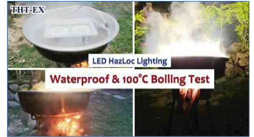
ランプの防水& 100°C沸騰水試験
